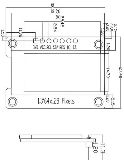
中景园电子1.3寸OLED模组结构图
