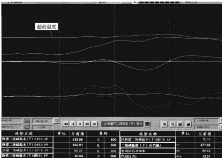
图 3-31 负荷改变与温度波动的曲线图
