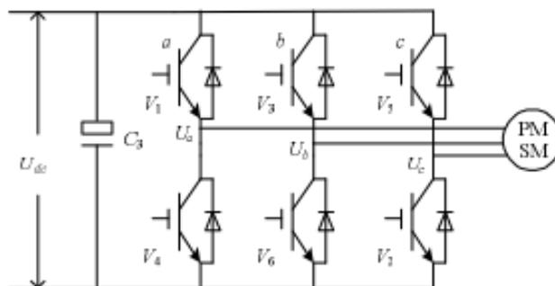
由于逆变器三相桥臂共有 6 个开关管，为了研究各相上下桥臂不同开关组合时逆变器输出的空间电压矢量，特定义开关函数  $S_x(x = a, b, c)$  为：
