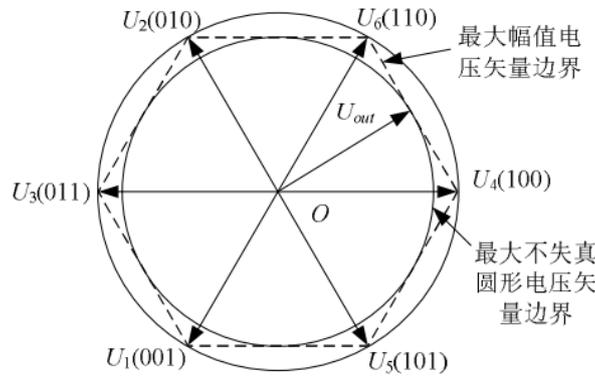
如图当合成电压矢量端点落在正六边形与外接圆之间时, 已发生过调制, 输出电压将发生失真, 必须采取过调制处理, 这里采用一种比例缩小算法。定义每个扇区中先发生的矢量作用为  $T_{Nx}$ , 后发生的矢量作用时间为  $T_{Ny}$ 。当  $T_x + T_y \leq T_{NPWM}$  时, 矢量端点在正六边形之内, 不发生过调制; 当  $T_{Nx} + T_{Ny} > T_{NPWM}$  时, 矢量端点超出正六边形, 发生过调制。输出的波形会出现严重的失真, 需采取以下措施:
