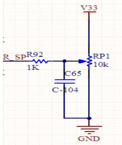
如实物所示电位器的旋转方向按照箭头所示增加转速：**RP1** 为速度输出给定接口，顺时针旋转速度增大，逆时针旋转到最右边则电机关闭，顺时针旋转电位器输出电压 **0.15V** 左右电机开始启动。
