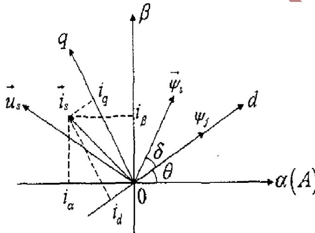
从三相定子坐标系 (A, B, C 坐标系) 变换到静止坐标系 ( $\alpha$ ,  $\beta$  坐标系) 的关系式为：
