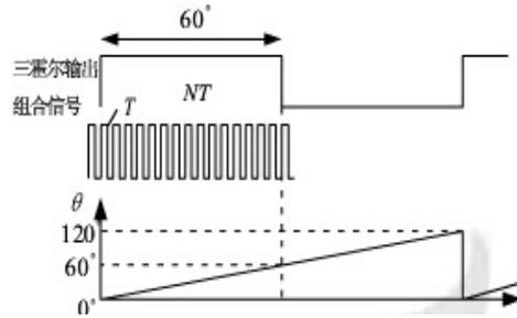
实际计算中，如图 1 所示，在  $(N_2T)$  时间段内，使用的是上一扇区计算得到的转速平均值  $\omega_1$  来计算转子位置，因此，在  $(N_2T)$  时间段内，转子位置为：
